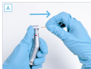
A. 拆卸车针 • 从手机机头取下车针。
