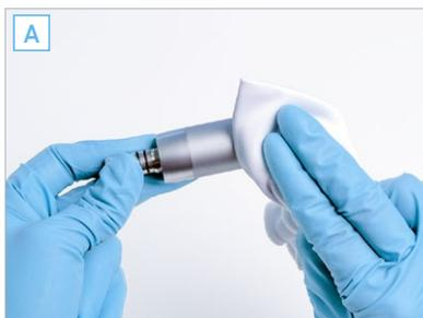
A. DISINFEZIONE CON UN DISINFETTANTE PER SUPERFICI (osservare le istruzioni per l'uso del produttore)
