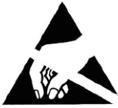
Il dispositivo contiene componenti sensibili alle scariche elettrostatiche (ESD) e occorre osservare le opportune precauzioni di manipolazione.
