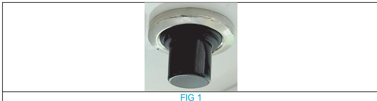
Si le système iOptima<sup>INT</sup> se bloque ou présente un dysfonctionnement quelconque, il est possible de le redémarrer en appuyant sur le bouton de réinitialisation. Ce bouton de réinitialisation se situe à proximité de l'appareil Apple et est facilement accessible à tout moment. Consulter la FIG 1 pour voir à quoi ressemble le bouton de réinitialisation.
