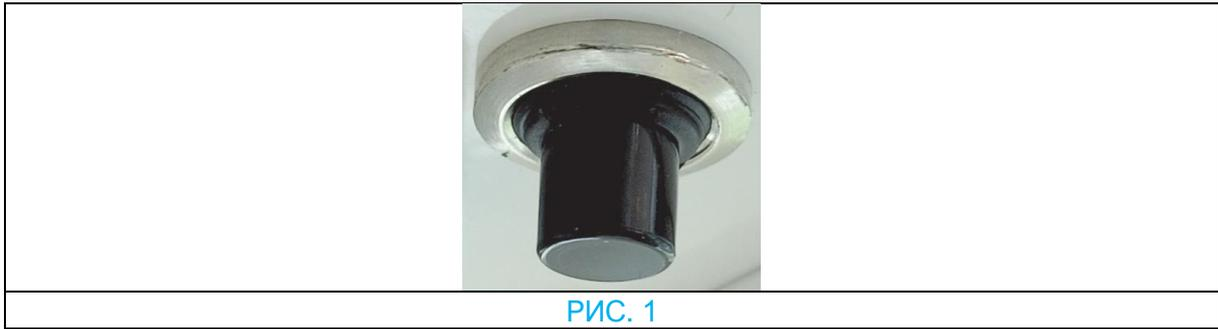
Если система iOptima<sup>INT</sup> зависает или работает со сбоями, можно перезагрузить всю систему, нажав кнопку перезагрузки системы. Кнопка перезагрузки расположена рядом с устройством Apple и всегда легко доступна. Изображение кнопки перезагрузки приведено на РИС. 1.
