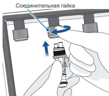
1. Откройте переднюю дверцу и убедитесь, что установленный режим соответствует типу соединительной муфты. Установите более толстую трубку муфты справа и вставьте муфту в соединитель.
