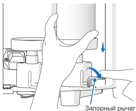
1. Поверните рычаг блокировки вниз в направлении по часовой стрелке.
