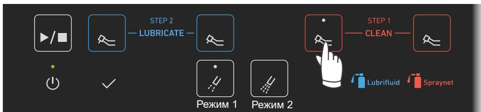
1. Нажмите соответствующие селекторные переключатели для линий, чтобы начать техническое обслуживание наконечника.
