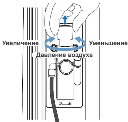
4. Потяните регулировочный диск на регуляторе воздуха вверх и поверните так, чтобы настроить давление воздуха на 0,3—0,5 МПа.
